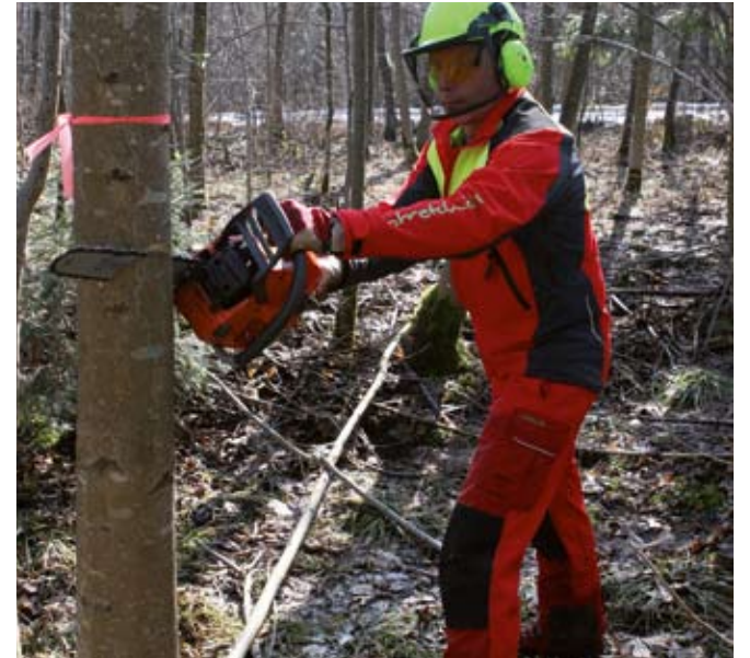
Beim Abstocken den Fällschnitt von der Zugseite her beginnen. Mit ausgestreckten Armen sägen und nicht zu nah am Baum stehen
