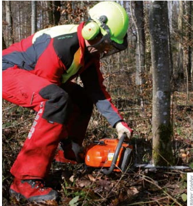
Der Schrägschnitt: Säge ansetzen und in den Stamm ziehen
