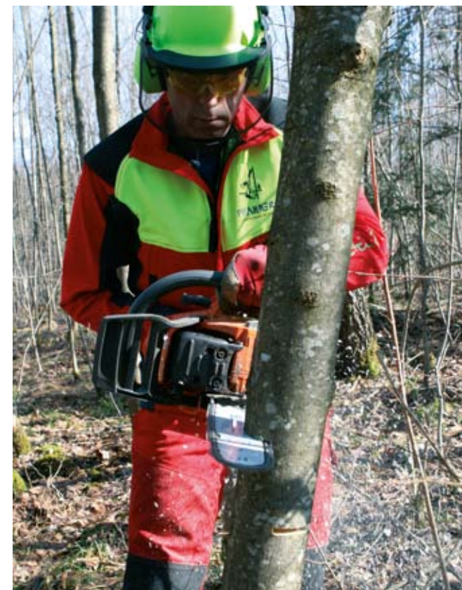
Beim Klappschnitt müssen sich beide Schnitte überlappen
