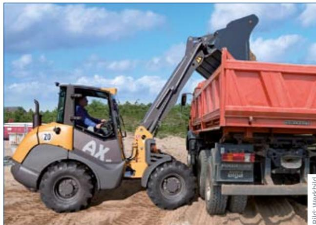
Ahlmann AX 1000 Highlift beim Beladen eines Lkw
